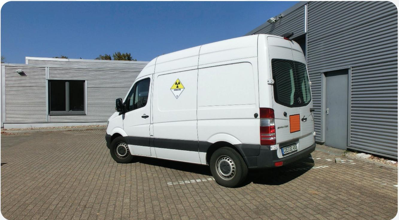
Signalisation des véhicules avec panneau d'avertissement orange et panneau de transport de classe 7
