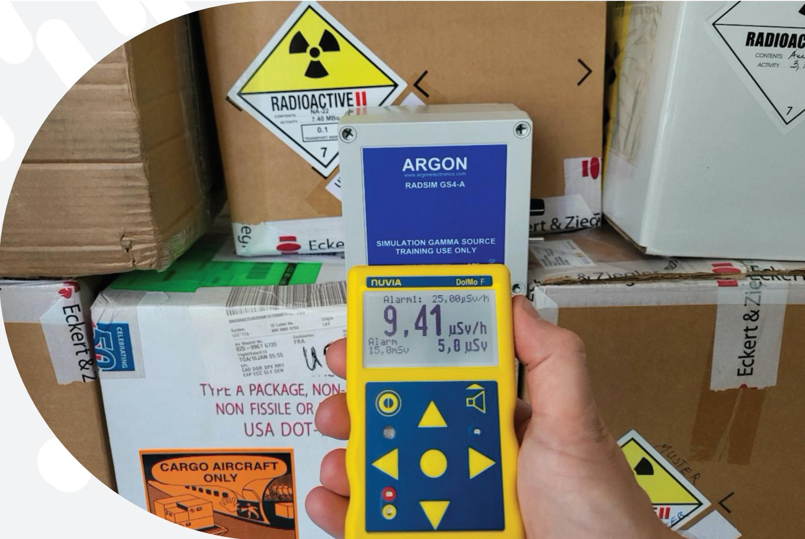
Les nouveaux appareils de formation DoIMo SIM (Radiamètre pour la mesure de la dose et du débit de dose) et CoMo- 170 SIM contaminamètre pour la détection de la contamination) permettent une formation axée sur la pratique des responsables de la radioprotection et des premiers intervenants. Les appareils techniquement modifiés réagissent aux ondes radio (DoIMo SIM) ou aux champs magnétiques (CoMo SIM) et peuvent donc être utilisés pour des scénarios de formation sans sources radioactives.
